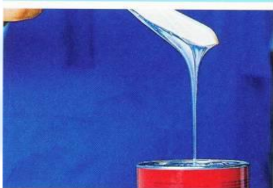
5-расм. Елимнинг суюқлик даражасини аниқлаш
