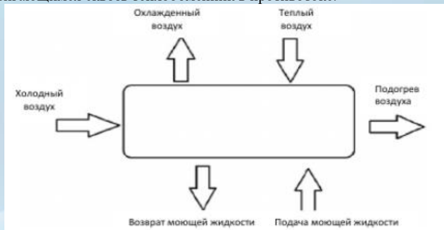
Рис. 1. Блок-схема рекуператора типа «воздух-воздух»
